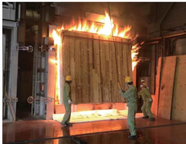
日本住宅・木材技術センターの耐火炉で実施された、CLT現し壁の準耐火構造加熱実験。木材が毎分約1mmの速度でゆっくり燃え進むことを利用して、厚さ90mmのCLTが1時間で約40mm燃えた際にも壁が燃え抜けないことを確認。
